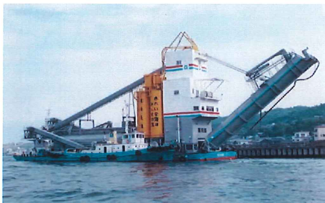
コンクリートプラント船
